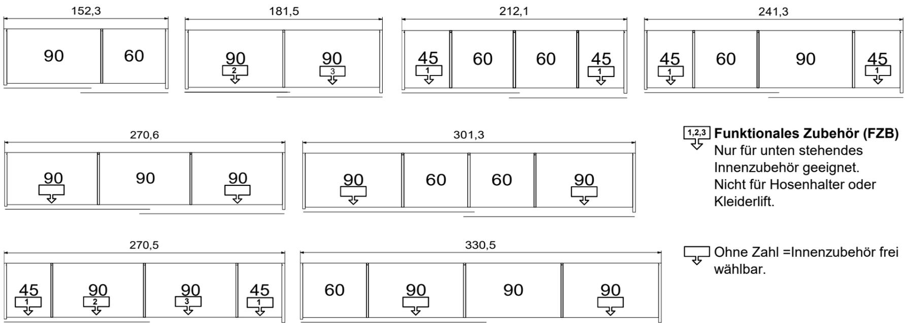
Innenschubkästen (ISK) für Schwebtüren, müssen mit einer Blende L/R ausgestattet sein, damit sie bei aufgeschobener Tür zu öffnen sind. In den äußeren Elementen können auch die standard ISK von der Zubehör (ZB) Seite geplant werden.
